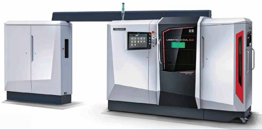
Beim Selektiven Laser-Schmelzen (im Bild eine im Projekt verwendete Anlage von DMG Mori) wird ein Laserstrahl über eine auf ein Werkstück aufgetragene Schicht Metallpulver geführt und dieses dadurch selektiv aufgeschmolzen.
