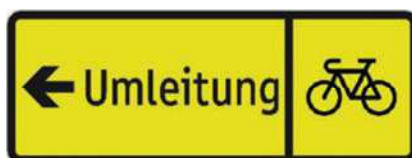
Abbildung 73: Hinweiszeichen für Umleitung des Radverkehrs; Format: mindestens 630 x 230 mm
