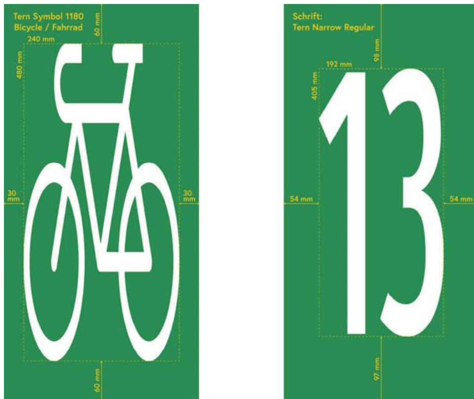
Abbildung 76: Form und Abmessungen der Elemente einer Bodenmarkierung zur Wegweisung (3/3)
