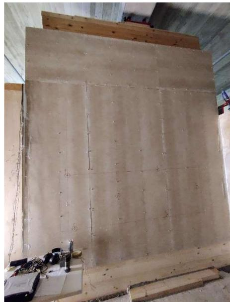
Abbildung 28: (oben) Unbeplankter Prüfstandsaufbau ohne Decke; (unten) Fertiger Prüfstandsaufbau eines T-Stoßes und geschlossenem Empfangsraum in Holzrahmenbauweise
