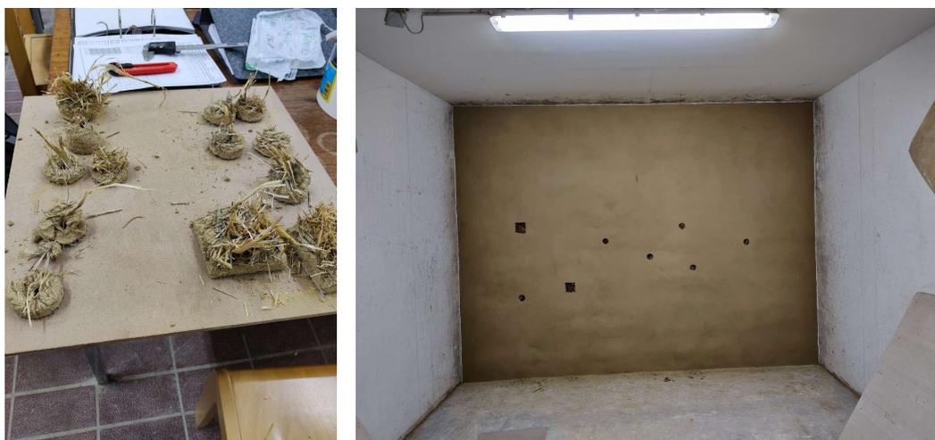
**Abbildung 58** Entnommene Lehmputzproben (links), Entnahme der Putzproben im Empfangsraum (rechts)
