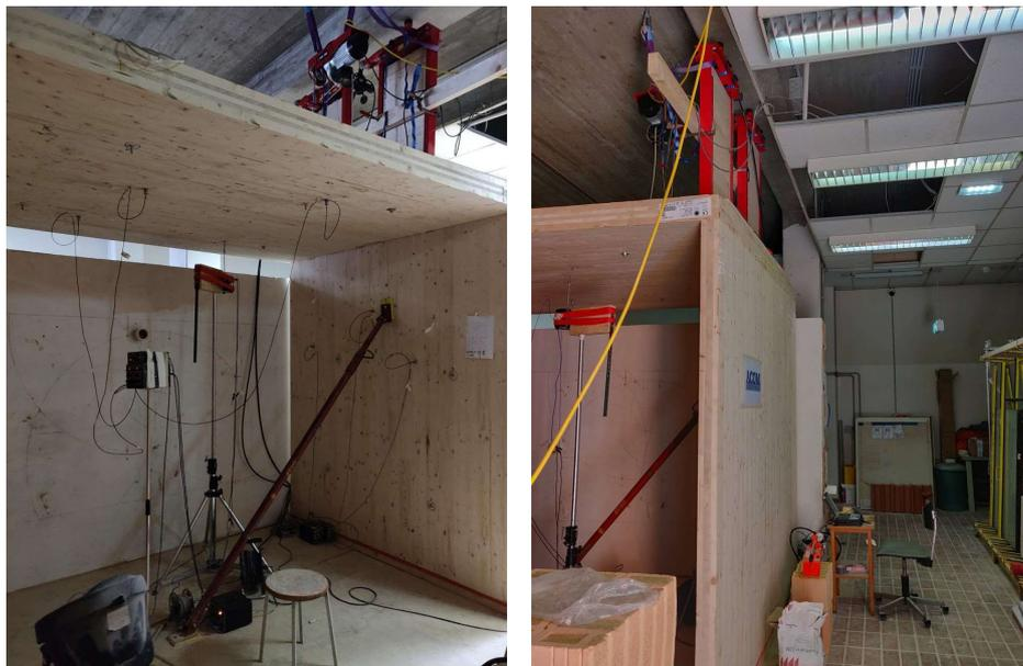
Abbildung 5: Messaufbau zur Bestimmung des Stoßstellendämm-Maßes entsprechend der Normenreihe ÖNORM EN ISO 10848 (Ausgabe 2018)
