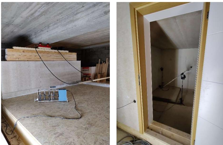
Abbildung 33: (links) Norm-Hammerwerk auf der zu untersuchenden Holzrahmendecke; (rechts) Drehgalgenmikrofon zur Schalldruckpegelmessung im Empfangsraum
