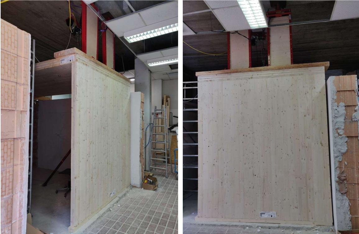
Abbildung 2: Wand-Decken-Knoten aus Brettsperrholzelementen (Wand 100 mm, Decke 140 mm)
