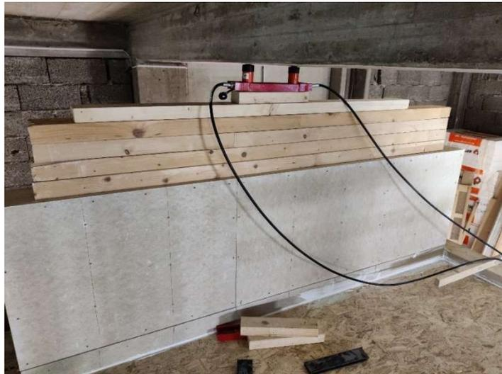
Abbildung 30: Einrichtung zur Pressung des T-Stoßes in Holzriegelbauweise
