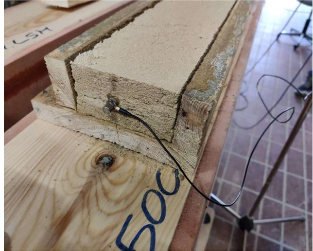
Abbildung 56 Messung der Laufzeitunterschiede der quasi-longitudinalen Wellen im Balken zur Berechnung des dynamischen E-Moduls (links - Messprinzip, rechts – Beschleunigungsaufnehmer am Balkenende)
