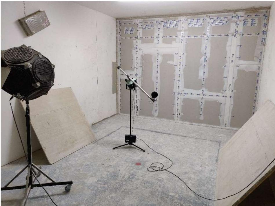
Abbildung 46 Prüfaufbau entsprechend ÖNORM EN ISO 10140-2 zur Messung des Luftschalldämm-Maßes der Wandkonstruktion
