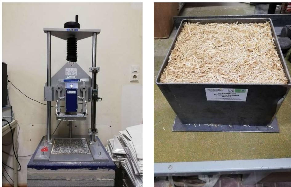
Abbildung 49 Messung der dynamischen Steifigkeit in Anlehnung an ÖNORM EN 29052-1 – Messapparatur (links); Probekörper (rechts)
