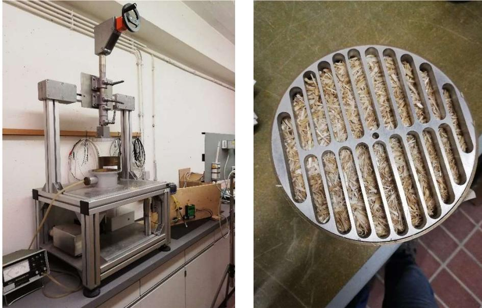
Abbildung 50 Messung des Strömungswiderstandes in Anlehnung an ÖNORM EN ISO 9053-1 – Messapparatur (links); Probekörper (rechts)
