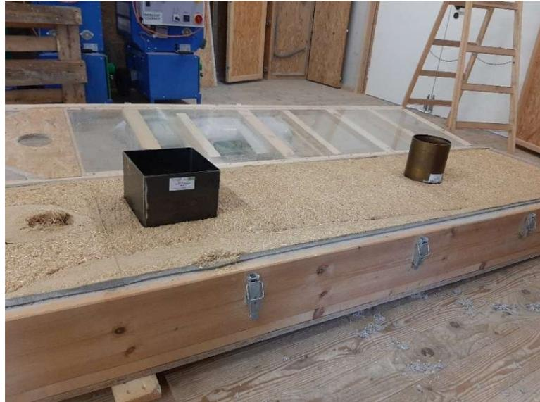
*Abbildung 48 Probenentnahme für die Messung der dynamischen Steifigkeit und des Strömungswiderstands aus einem ausgeblasenen und wieder geöffneten Hohlraum einer Holzständerwand*
