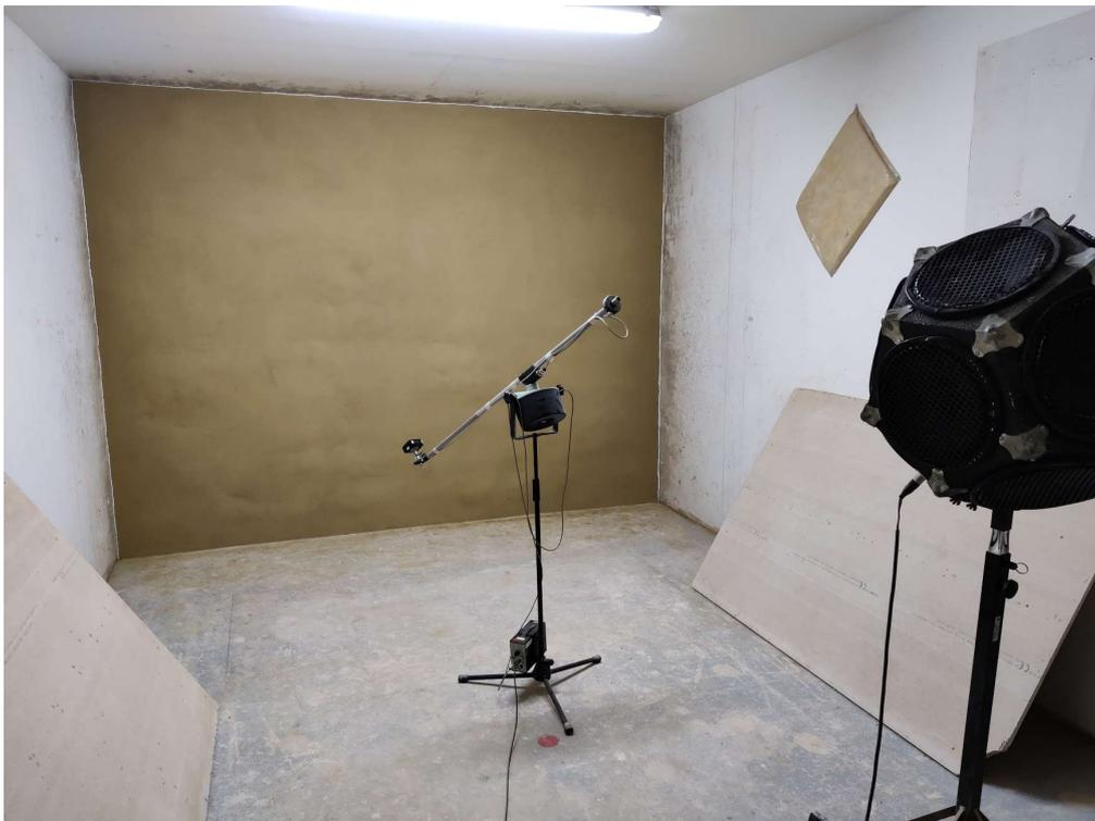
*Abbildung 54 Prüfaufbau entsprechend ÖNORM EN ISO 10140-2 zur Messung des Luftschalldämm-Maßes der fertigen Wandkonstruktion*
