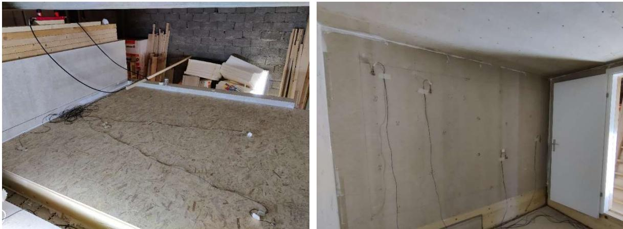
Abbildung 31: Messaufbau zur Bestimmung der richtungsgemittelten Schnellepegeldifferenz  $\overline{D_{v,ij}}$  entsprechend der Normenreihe ÖNORM EN ISO 10848 (Ausgabe 2018)
