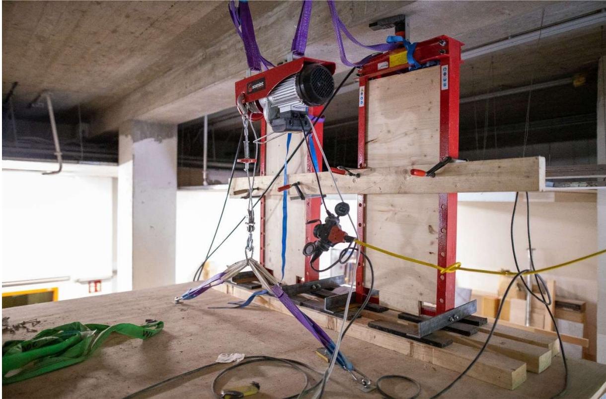
Abbildung 3: Einrichtung zur Pressung des Bauteilstoßes
