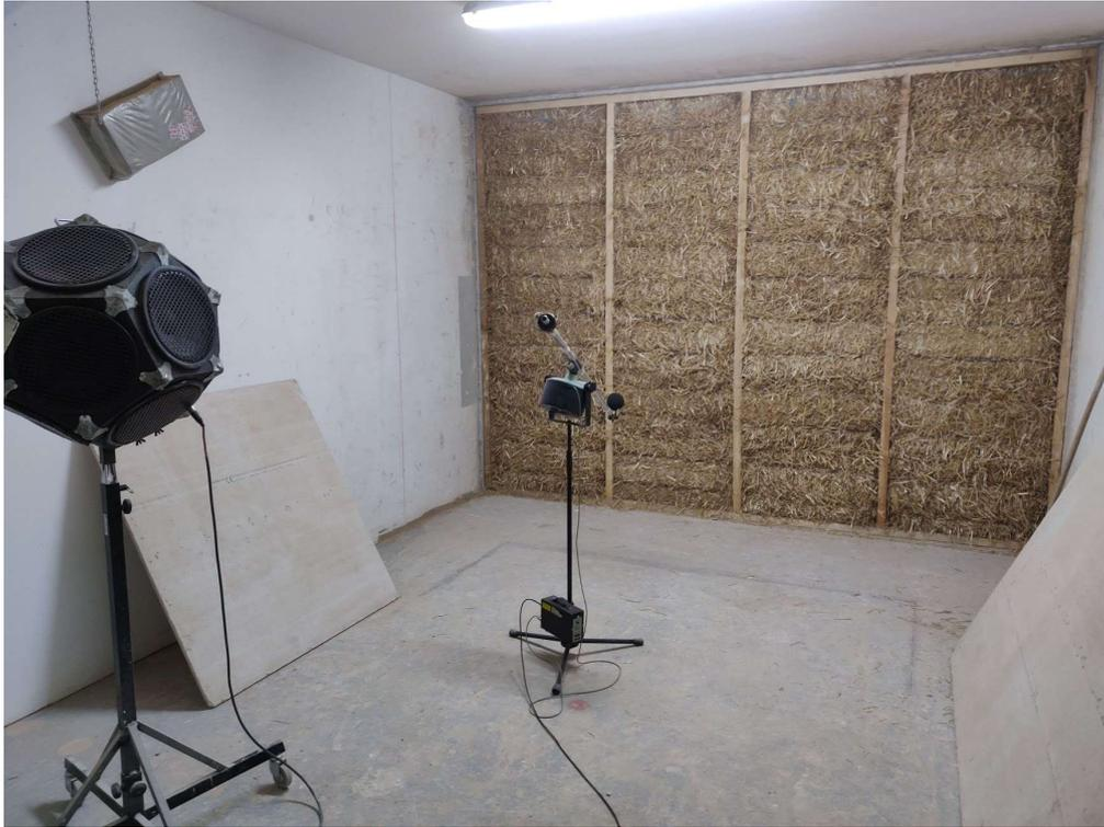
*Abbildung 53 Prüfaufbau entsprechend ÖNORM EN ISO 10140-2 zur Messung des Luftschalldämm-Maßes der unverputzten Wandkonstruktion*
