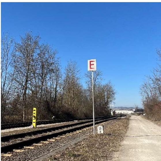
Abb: Signal Fahrwegende Gleis 1H
