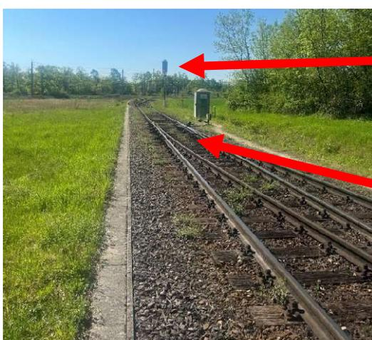
Abb: Weiche 2H, dahinter Hauptsignal Mh1
